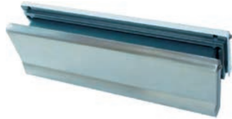
V 244S-13 | Edelstaal = smalle uitvoering B 260 x H 82 mm Freesmaat B 235 x H 55 mm
